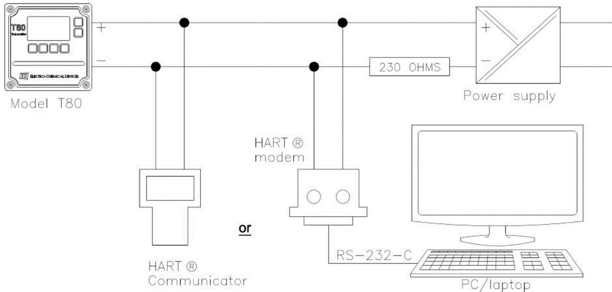
**Figure 3-8: Wiring Diagram**
